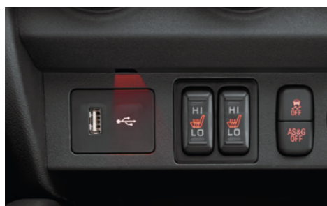
Podgrzewane siedzenia przednie | z dwustopniową regulacją.
